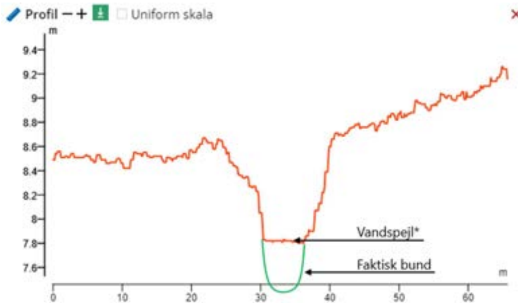
Figur 5.6: Eksempel på tværsnit som indgår i vandløbsmodellerne (Orange linje). *Vandspejl ved opmåling af Danmarks Højdemodel 0,4 m grid nyeste udgave. Vandspejlet udgør bunden af det vandløbsprofil der indgår i vandløbsmodellen. Den faktiske bund og geometri i vandløbene afviger fra højdemodellen og princippet herfor kan ses af den grønne linje.
