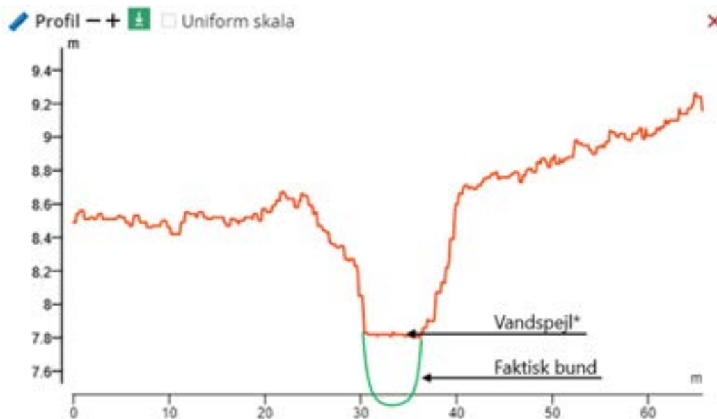
Figur 4.3: Eksempel på tværsnit som indgår i vandløbsmodellerne (Orange linje). *Vandspejl ved opmåling af Danmarks Højdemodel 0,4 m grid nyeste udgave. Vandspejlet udgør bunden af det vandløbsprofil der indgår i vandløbsmodellen. Den faktiske bund og geometri i vandløbene afviger fra højdemodellen og princippet herfor kan ses af den grønne linje.
