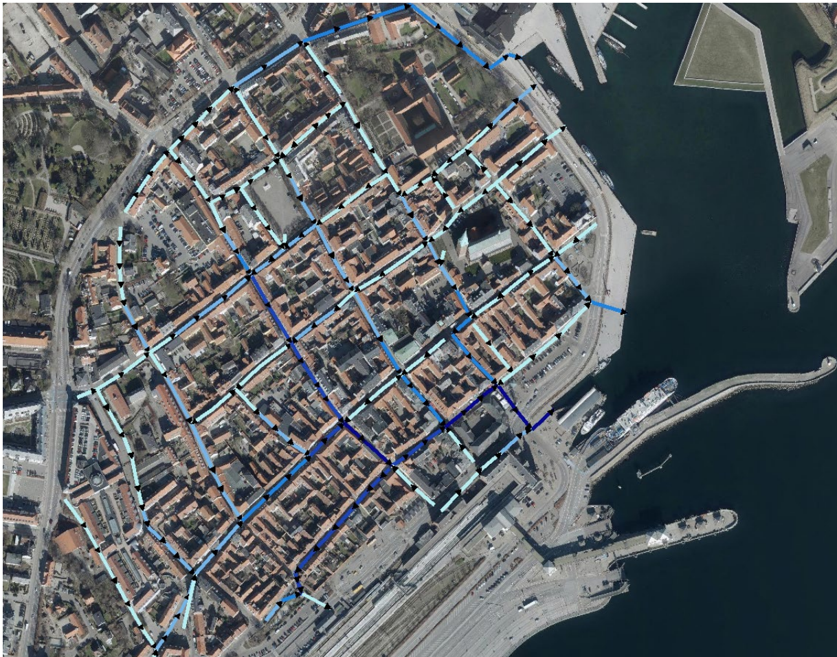
Figur 8: Regnvandsrender til klimatilpasning af et fremtidigt regnvandssystem er vist med blå. Med lysblå er vist de små render og med mørk de store. De sorte pile viser strømningsretningen i renderne.
