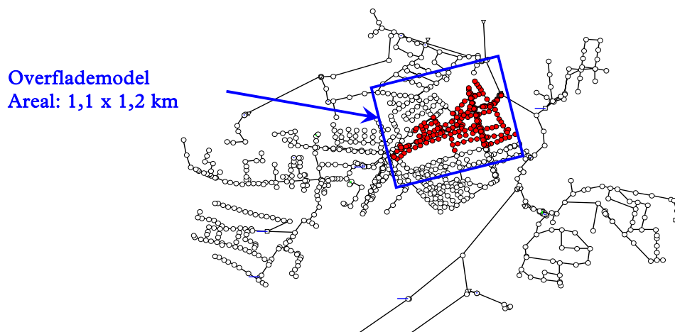
Figur 5. Beregningsområde for overflademodel, samt afløbsmodellen. Rød angiver de brønde i afløbsmodellen (MOUSE), der er koblet til overflademodellen (MIKE 21).
