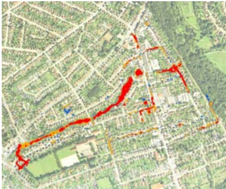
Figur 7. Oversvømmede områder med eksisterende ledningsnet. Beregning er gennemført for gentagelsesperioder på 10 (rød), 50 (blå), 100 (orange) år. Der er anvendt en sikkerhedsfaktor på 1.2, samt en klimafaktor på 1.2. (Klimascenarium A2).
