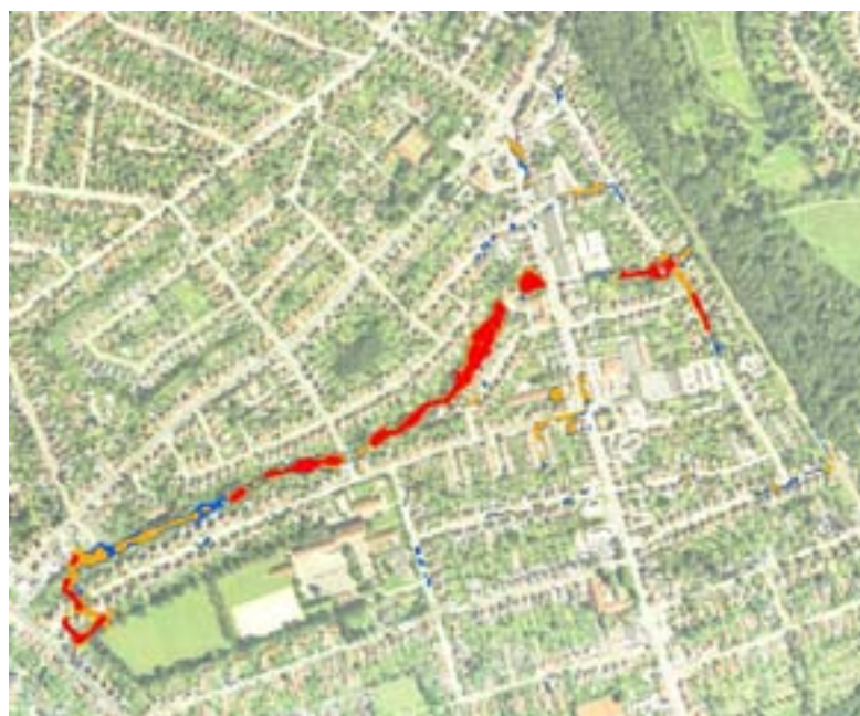
Figur 6. Oversvømmede områder med eksisterende ledningsnet. Beregning er gennemført for gentagelsesperioder på 10 (rød), 50 (blå), 100 (orange) år.
