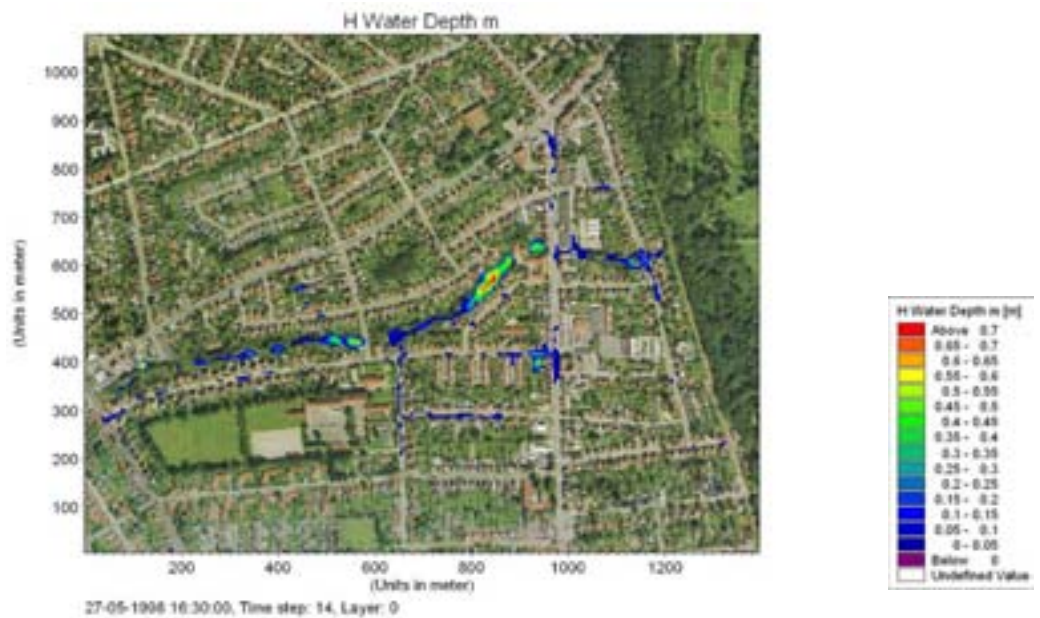
Figur 9. Vanddybder i oversvømmede områder ved eksisterende ledningsnet. Beregning er gennemført for en gentagelsesperiode på 50 år uden hensyntagen til sikkerhedsfaktorer og klimaeffekter.
