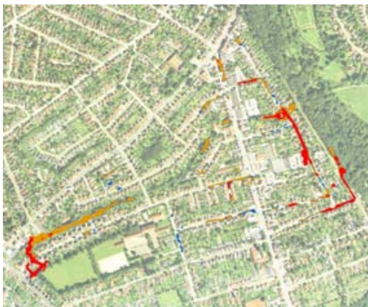
Figur 8. Oversvømmede områder ved udbygget ledningsnet. Beregning er gennemført for gentagelsesperioder på 10 (rød), 50 (blå), 100 (orange) år. Der er anvendt en sikkerhedsfaktor på 1.2, samt en klimafaktor på 1.2 (Klimascenarium A2).
