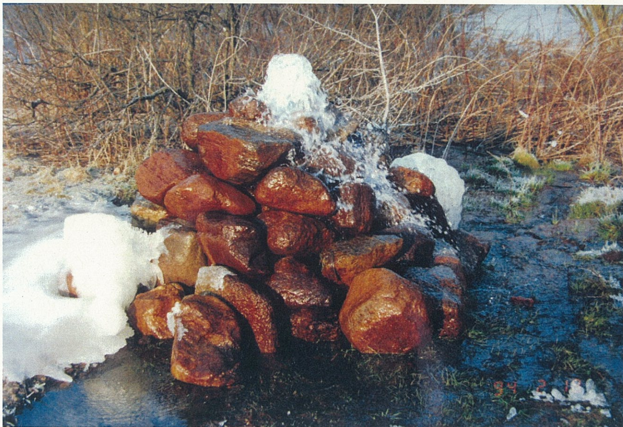
Iltning af grundvand før udledning
