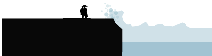
4.17 Brus Tilladt bølgebrus helt oppe ved kajens kant
