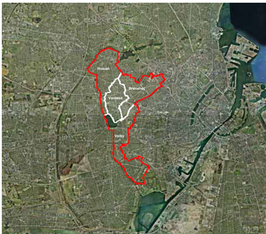
Figur 5. Afgrænsning af kloakoplande i Københavns og Frederiksberg kommuner, der har overløb til Harrestrup Å. Harrestrup Å løber fra nord mod syd langs den vestlige oplandsgrænse, og passerer Damhussøen før udmunding i Kalveboderne, der ses nederst i midten af billedet. © Google Earth.
