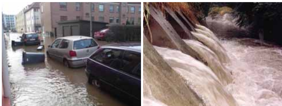
Figur 1. For lille afvandingskapacitet fører til to typer af problemer: 1) kloakvand kommer op af de forkerte steder, f.eks. i kældrene i private hjem, eller på gaderne, hvor vandet dels kan komme op af kloakken, eller regnvandet ikke kan løbe ned fordi kloakken er fyldt. 2) for mange aflastninger, hvilket betyder at blandingen af regn og almindeligt spildevand sendes urensset direkte til et vandløb.
