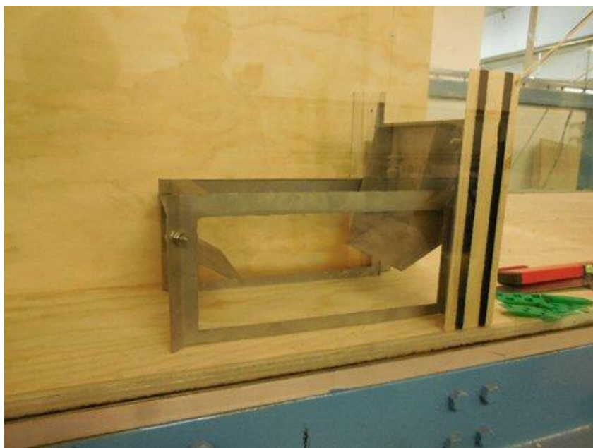
Figur 6: Test af den faunapassable vandbremse på AAU
