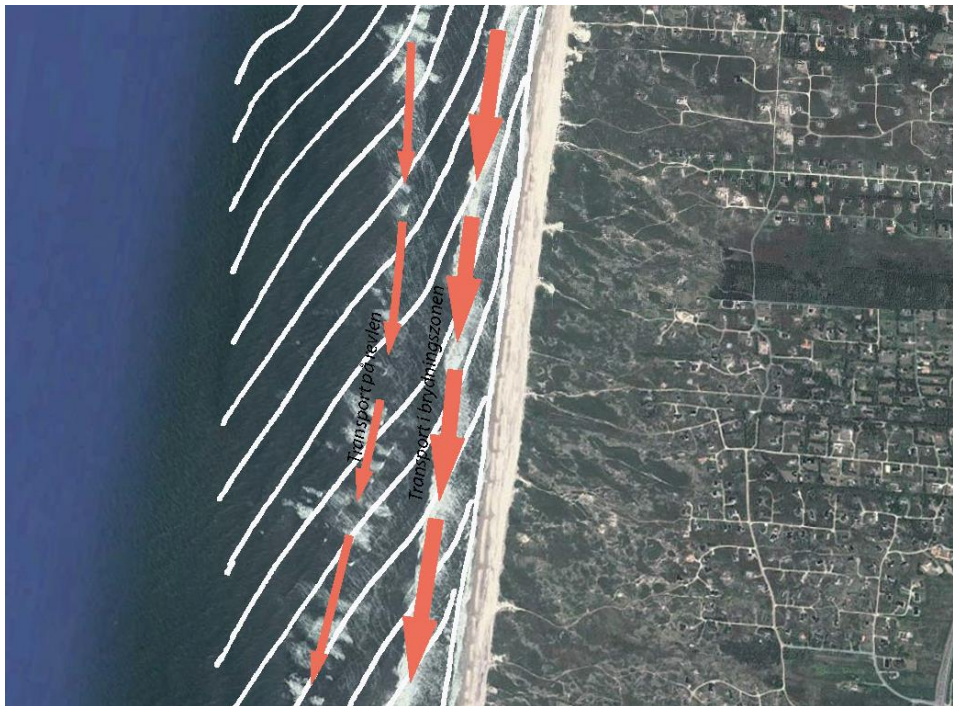
Figur 2.15 Bølger, som falder ind på en strand og driver en langsgående transport. Hvide linjer viser bølgetoppe. Orange pile indikerer langstransportens retning og størrelse.
