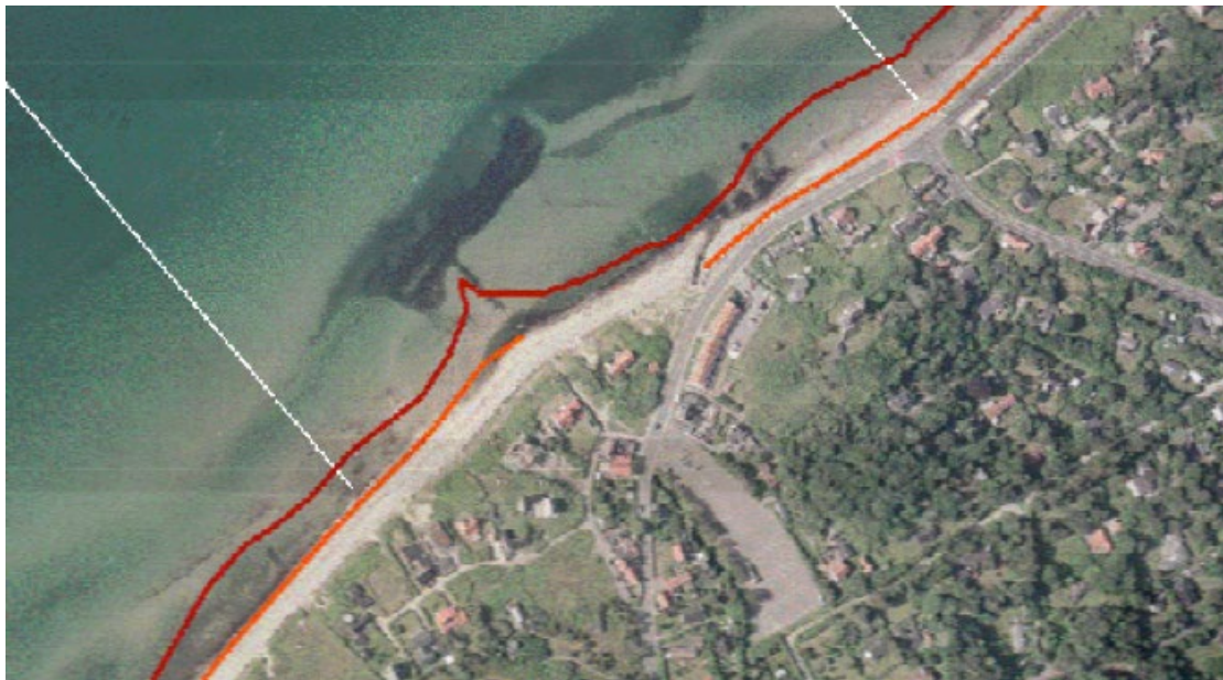
Tilbagerykning af kysten ved Rågeleje fra 1954 til 2009. Mørkerødt: Vandlinje i 1954. Orange: Skræntfod i 1954. Illustration: COWIs skitseprojekt Sandfodring ved Nordkysten, 2009, figur 4-6.
