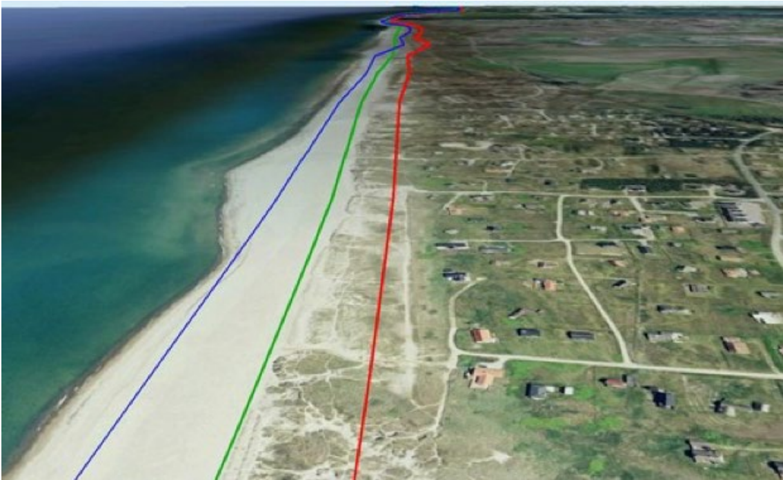
Vejlbj Klit fra 1983 til nutiden. Den blå linje viser, hvor klitskrænten var i 1983, den grønne linje viser klitskrænten i 2011, og den røde linje viser, hvor klitskrænten ville være, hvis man ikke havde foretaget kystbeskyttelse. Illustration: Kystdirektoratet.
