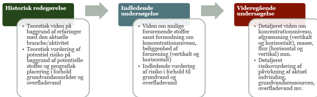
FIGUR 1.4 DET OVERORDNEDE FLOW FOR VURDERING AF RISIKOEN AF EN POTENTIEL ELLER KENDT JORDFORURENING FRA EN LOKALITET FORDELT PÅ DATAGRUNDLAGET FOR DE ENKELTE FASER.
