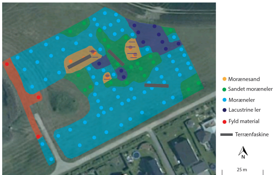
Figur 1. Geologisk kort over forsøgsområdet i Mårslet og placering af de tre terrænfaskiner. Området viser stor geologisk variation. Moræneler udgør den største del af området.
