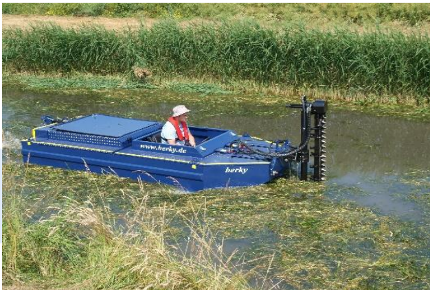
Figur 5-14 Grødeklipping med frontmonteret klipper
