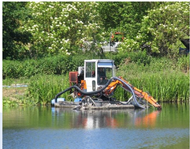
Figur 6-6: Cuttersuger på pram
