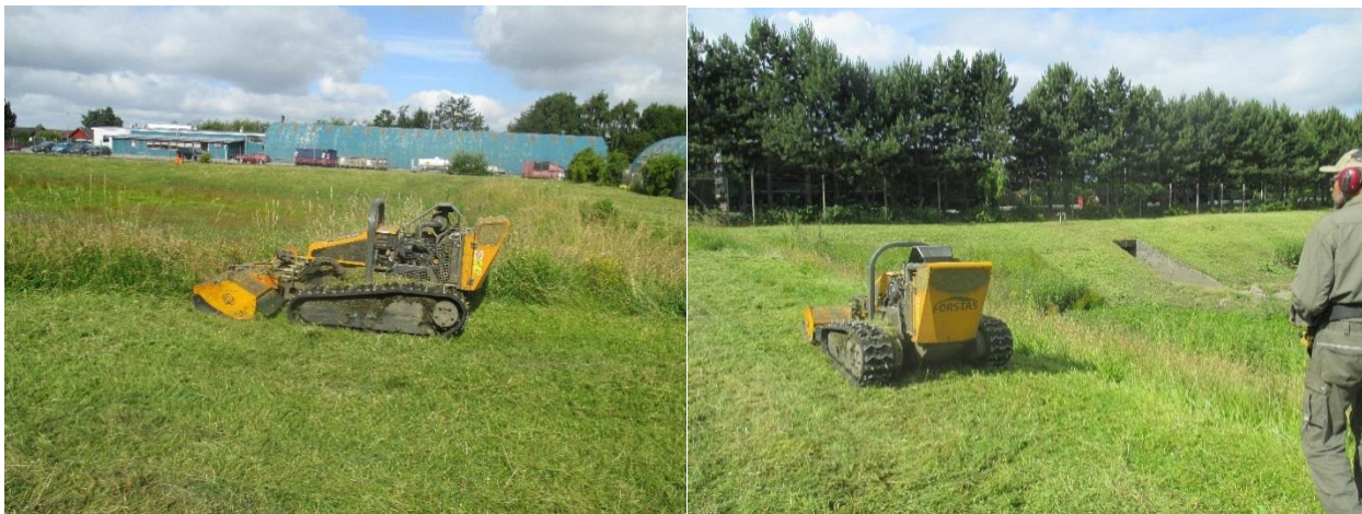
Figur 5-4: Robotklipper til brug på eksempelvis stejle skråninger
